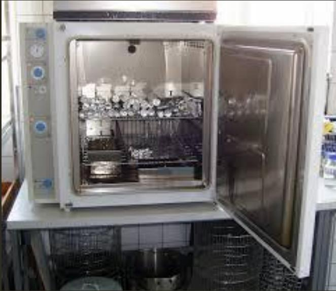
Los hornos de aire caliente, también llamados hornos de calor seco, son dispositivos eléctricos utilizados para esterilización que forman parte del equipamiento de laboratorio. El horno utiliza calor seco para esterilizar los objetos que se introducen en él por 120 minutos a 170 °C. Una vez pasados esos 120 minutos se retiran del horno y se dejan enfriar por 2 horas.
