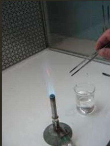
Se trata del calor que produce una llama de gas o alcohol, es un procedimiento de emergencia y consiste en colocar directamente en la llama el objeto que se desea esterilizar.
